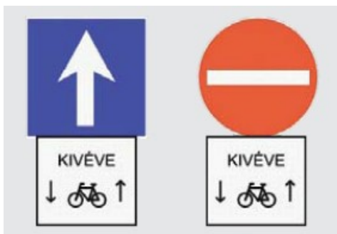
4. ábra: Egyirányú utcában a kétirányú kerékpáros forgalom jelzése
